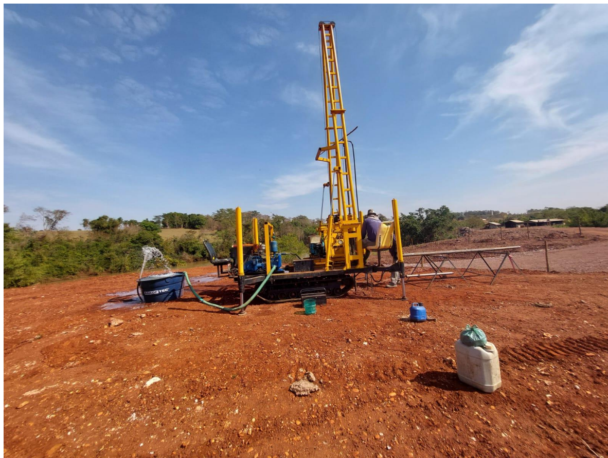
Figura 13.2: Modelo da Perfuratriz, utilizado para perfuração dos poços. Fonte: C-nível, 2022.
