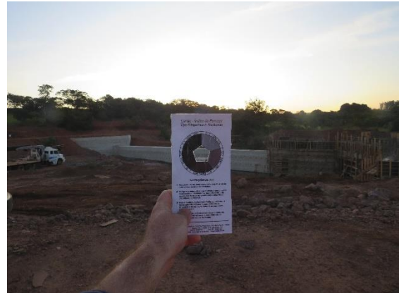
Figura 7.10: Técnico aferindo a emissão de poluentes através da escala de Ringelmann - 2º Relatório. Fonte: C-nível, 2022.
