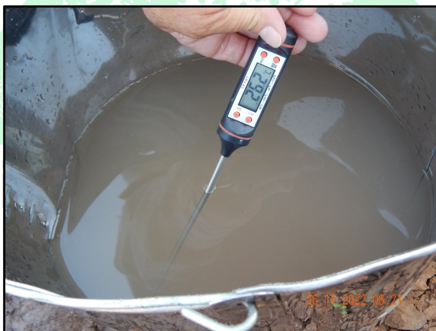
Foto 04 - Aferição da temperatura da água no momento da coleta. Foto: Biólogo Emilio Sergio Gonçalves, novembro 2022.
