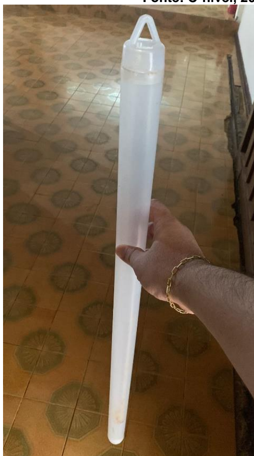
Figura 13.7: Bailer descartável, utilizado para realização da coleta. Fonte: C-nível, 2022.
